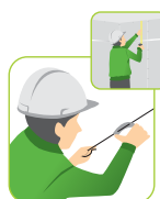
2. ประกอบชุดลวดปรับระดับ โดยใช้สปริงปรับระดับ (Rod Joiner) เชื่อมต่อระหว่างลวด 4 มม. เข้ากับชุดหัวโครงป.ปลา
