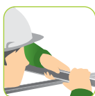
5. ล็อกโครง SCL แนวนอนเข้ากับโครงแนวตั้งด้วยกิ่งล็อก
