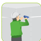
1. ติดตั้งฉากริมนำเข้ากับผนังโดยรอบ ตามระดับที่กำหนด
